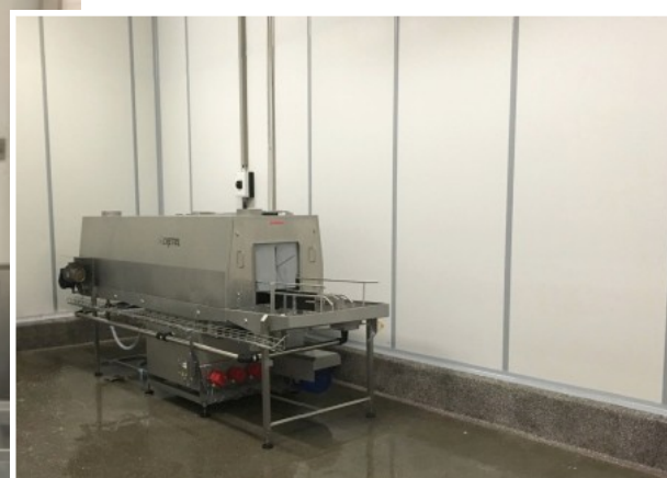
De bakkenwasruimte is gerenoveerd met polyester Becopanelen
